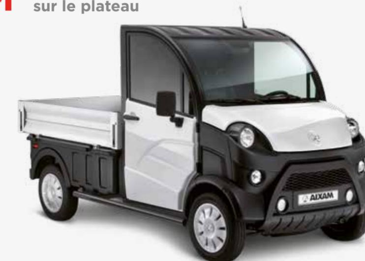
Les ridelles amovibles et rabattables permettent un confort d'utilisation optimal et font preuve d'une exceptionnelle modularité. Pour plus d'adaptabilité, le plateau ridelles peut être accessoirisé de rehausse grillagées.
